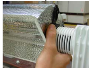
Reflector in houder plaatsen
